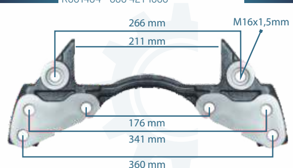
111330 CALIPER CARRIER MB ATEGO K001494 - 000 421 1306
